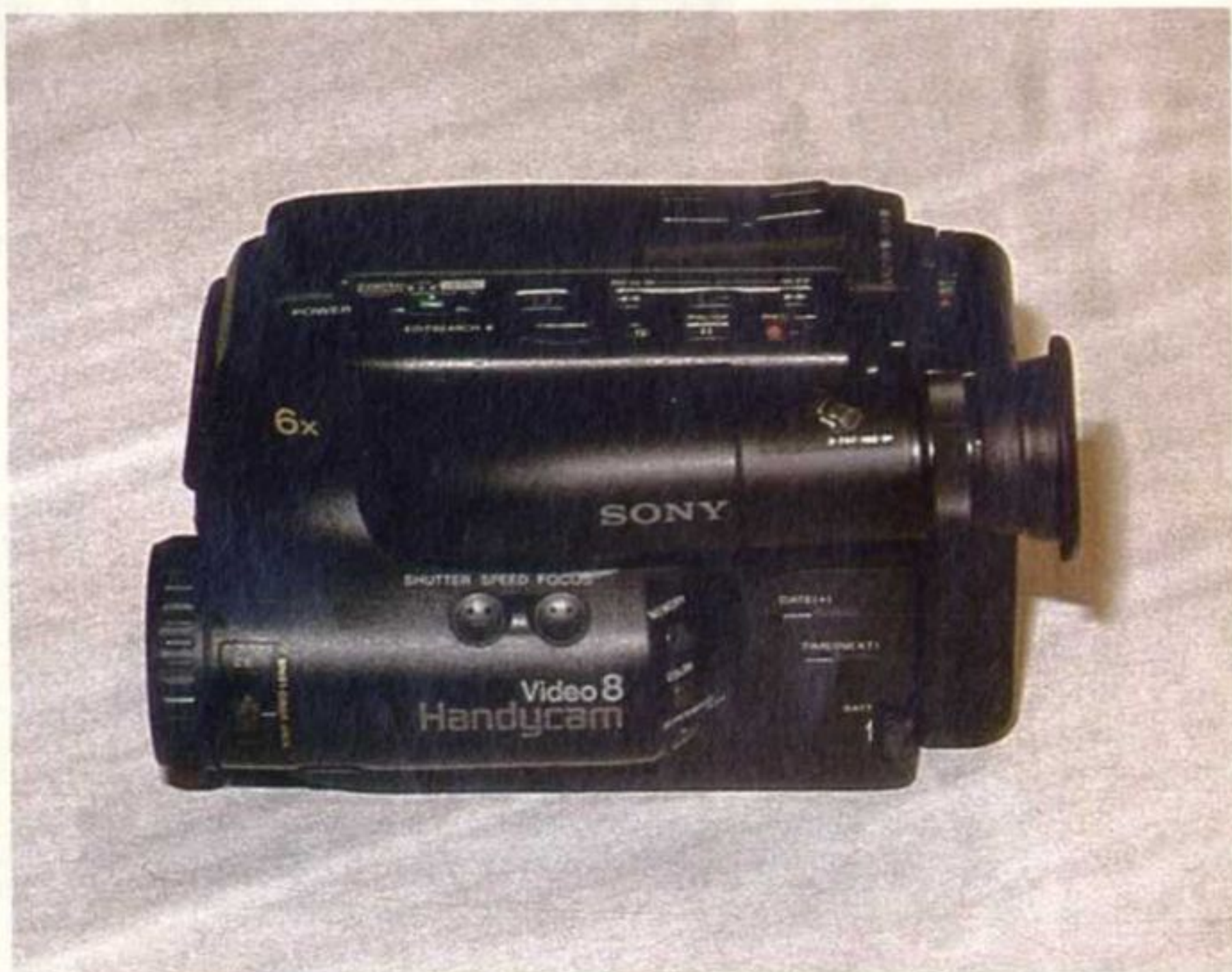
Camcorder do sistema 8mm: compacta e com capacidade para gravar até duas horas
